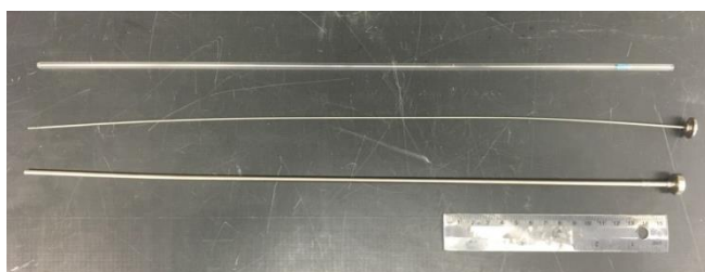
図 11. 上：シース管 中：注入器(中芯) 下：注入器
